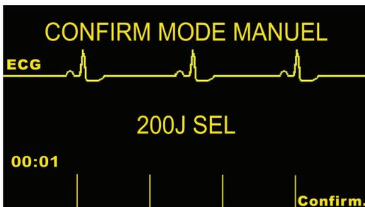
Si le code d'accès n'est pas configuré, le message "CONF. MODE MANUEL" et la touche de fonction de confirmation s'afficheront. Appuyez sur la touche de confirmation pour saisir l'opération en mode manuel. Si celle-ci n'est pas pressée dans les 5 secondes l'unité reviendra au mode d'opération semi-automatique.
