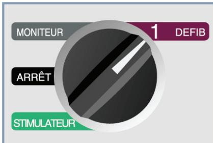
**Remarque :** Lorsque l'instrument est sur la position **MONITEUR** ou **DEFIB** et les palettes sont connectées au câble multifonctions, les "PAL. EXT." du défibrillateur sont la source de l'ECG.
